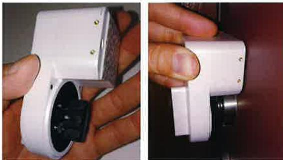
あとは本体にリチウム電池をセットして、専用アプリをインストールしたスマートフォンとbluetoothで接続するだけ。箱を開けてから30分程度で、スマートフォンによる鍵の操作が実現！
